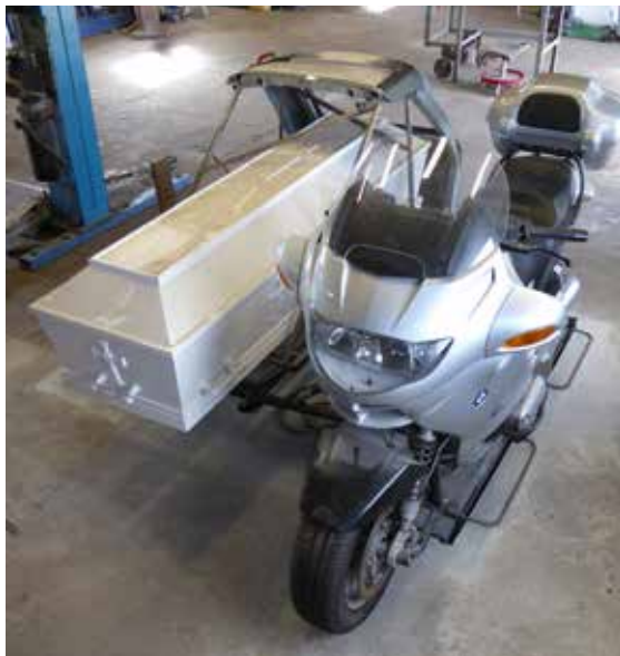
BMW R 1150 RT med EML sidevognsramme er valgt som udgangspunkt for den danske udgave af en mc-rustvogn.
